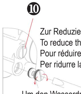
Zur Reduzierung des Wasserdrucks bis zum Absperren im Uhrzeigersinn drehen.
